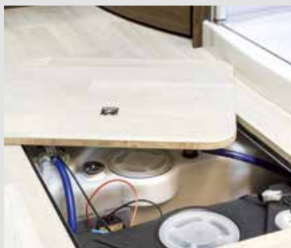
FRANKIA dubbele bodem: traploos en doorlopend verwarmd
