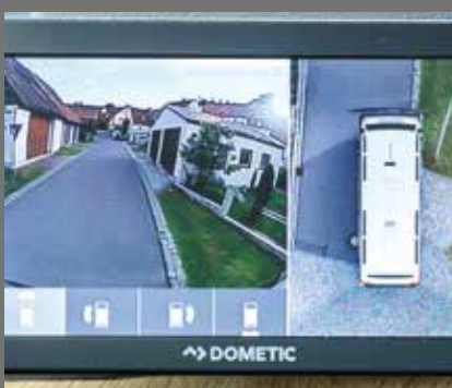
Alles in het oog: bird-view-cam met 360°-view en groot display
